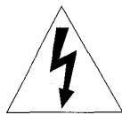
Le symbole représentant un éclair au bout en pointe de flèche placé à l'intérieur d'un triangle équilatéral est destiné à mettre en garde l'usager contre la présence d'une "tension dangereuse" non isolée dans le boîtier de l'appareil, tension suffisante pour constituer un risque d'électrocution pour les humains.
