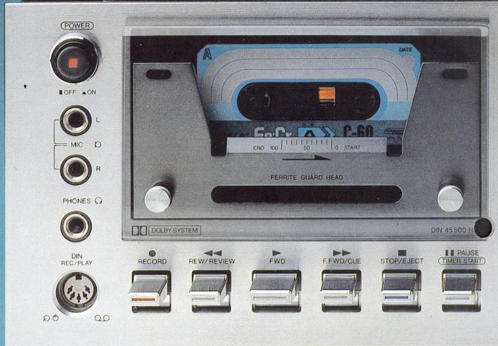
So funktioniert die Restbandanzeige: Auf dem Abwickelkern befindet sich ein 24poliger Magnet, der bei einer Drehung 24 Impulse abgibt. Diese Impulse werden von einem IC aufgenommen, verstärkt, umgewandelt und dem linken VU-Meter zugeführt. Wenn eine Cassette dem Ende zugeht, wickelt der Kern entsprechend schneller ab; die Bandgeschwindigkeit bleibt selbstverständlich konstant. Also zeigt die Nadel immer die verbleibende Restzeit an.
