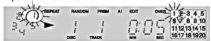
Para iniciar la reproducción con el mando a distancia Pulse uno de los botones DISC 1-5 para seleccionar un disco.
