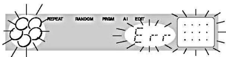
Cela signifie qu'une erreur s'est produite dans le mouvement du compartiment à disques. Il arrive que le compartiment à disques ne puisse se refermer. Un disque ou quelque chose doit être coincé dans le compartiment à disques. Dégagez-le et appuyez ensuite sur la touche ▲ OPEN/CLOSE pour refermer le compartiment.
