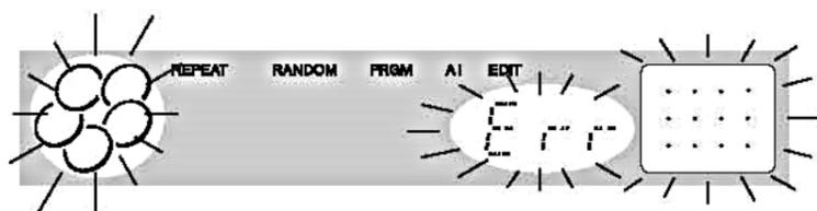
Esto significa que se ha producido un error en el movimiento del compartimiento de discos. No puede cerrarse el compartimiento de discos. Un disco u otro objeto se ha atascado en el compartimiento. Extráigalo y pulse el botón ▲ OPEN/CLOSE para cerrarlo.
