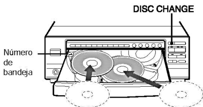
Para insertar de tres a cinco discos, pulse el botón DISC CHANGE para que las bandejas giren después de colocar dos discos. Coloque el siguiente disco en la bandeja vacía. Cada vez que pulse dicho botón, las bandejas giran y será posible colocar un disco.
