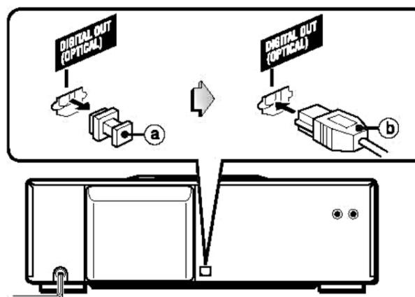
Cet appareil assure la sortie de signaux sonores numériques CD par le biais de cette prise. Utilisez un câble optique pour raccorder l'équipement audio numérique (amplificateur numérique, platine DAT, enregistreur MD, etc.). Retirez le bouchon anti-poussières (a) de la prise DIGITAL OUT (OPTICAL). Branchez ensuite la fiche d'un câble optique (b) à la prise DIGITAL OUT (OPTICAL).
