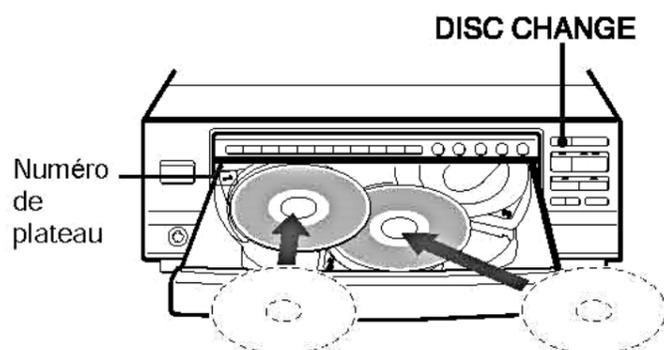
Pour charger trois à cinq disques, appuyez sur la touche DISC CHANGE pour faire tourner les plateaux après avoir placé deux disques. Placez le disque suivant sur le plateau vide. Chaque fois que vous appuyez sur la touche DISC CHANGE, les plateaux pivotent et un disque peut être introduit.
