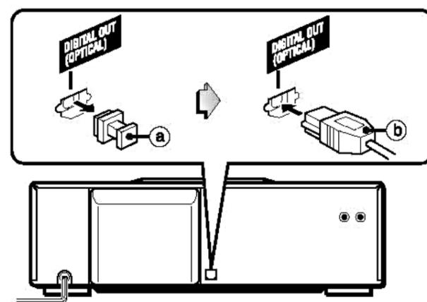
Esta unidad puede transmitir señales digitales de sonido de CD por esta toma. Utilice un cable óptico para conectar equipos de audio digitales (amplificador digital, platina de DAT, grabadora MD, etc.)
