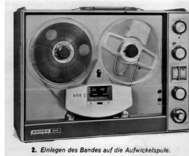
2. Einlegen des Bandes auf die Aufwickelspule.
