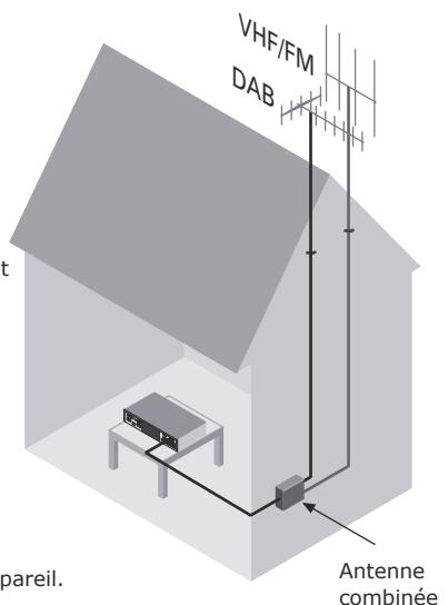
*Le type d'antenne à utiliser dépend de vos préférences acoustiques et des conditions régionales. Si vous n'écoutez que des émissions de la bande FM, par exemple, et que le signal FM est puissant dans votre région, une simple antenne omnidirectionnelle, installée au grenier ou sur le toit, fera l'affaire. Pour écouter la RAN dans une zone à signal faible, vous aurez besoin d'une antenne à fort gain montée sur le toit.*
