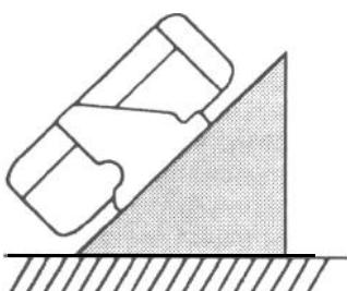
Der Einbau in einem Winkel von 45° ist nicht möglich, wenn nur **(A)** verwendet wird.
