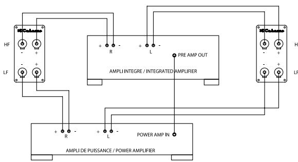
Im Falle einer Verwendung von Standard Lautsprechkabel müssen die Metallstränge an den Anschlussklemmen bleiben und der Anschluss erfolgt über das Paar Klemmen Ihrer Wahl.
