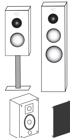
Le champ magnétique des moteurs des haut-parleurs va rayonner au delà de l'enveloppe de l'enceinte acoustique. Il faut donc éloigner d'environ 50 cm les appareils et objets sensibles à ce type de rayonnement (téléviseurs, écrans d'ordinateur, disquettes informatiques, bandes magnétiques audio ou vidéo, cartes à puces...). Les enceintes centrales ne sont pas concernées par ce type de problème car elles sont blindées magnétiquement.
