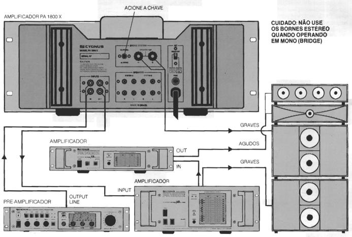
O amplificador CYGNUS PA 1800 X apresenta a possibilidade de operar em Mono. Nessa opção, os circuitos dos dois canais são interligados num esquema "ponte" (BRIDGE), em que a potência final do aparelho é entregue a apenas um dos canais, com valor praticamente dobrado. Assim, o amplificador PA 1800 X atinge 920 Watts IHF para carga de 8 ohms.
