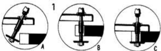
Übrigens: Die Transport-Sicherungsschrauben sind eine überraschend einfache und zuverlässige Lösung dreier Probleme. Diese beiden Schrauben halten den Plattenspieler auf seinem Sockel, sichern ihn während des Transportes und durch sie ist das Chassis ausschließlich von oben zu montieren.
