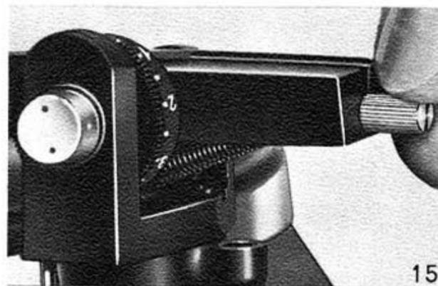
Durch Drehen der Rändelschraube nach links (bei Betrachtung des Gerätes von vorne) wird der Tonarm angehoben (entlastet), durch Drehen nach rechts senkt sich der Tonarm ab. Der Tonarm ist exakt ausbalanciert, wenn Kante „A“ des Tonarmprofils und Kante „B“ der Tonarmstütze auf gleicher Höhe sind (Fig. 16),
