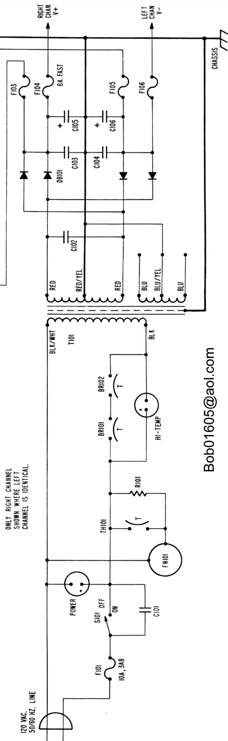
ONLY RIGHT CHANNEL SHOWN WHERE LEFT CHANNEL IS IDENTICAL.
