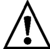
El signo de exclamación dentro de un triángulo equilátero alerta al usuario de la existencia de importantes instrucciones sobre funcionamiento y mantenimiento [asistencia] en la documentación que acompaña al equipo.
