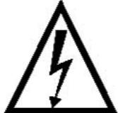
Il lampo con estremità a freccia contenuto in un triangolo equilatero rappresenta un allerta per l'utilizzatore, a significare la presenza di "corrente pericolosa" non isolata all'interno del cabinet del prodotto, corrente che potrebbe essere di magnitudine sufficiente a costituire un elemento di rischio di shock elettrico per le persone.
