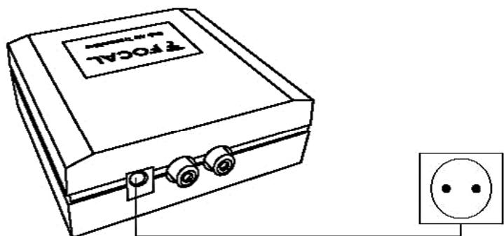
Connectez l'alimentation 5 volts du Sub Air transmitter.
