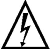
El símbolo del relámpago con punta de flecha, dentro de un triángulo equilátero, alerta al usuario de la presencia de una «tensión peligrosa» sin aislar en el interior del producto, que puede ser de la suficiente magnitud como para constituir un riesgo de descarga eléctrica para las personas.
