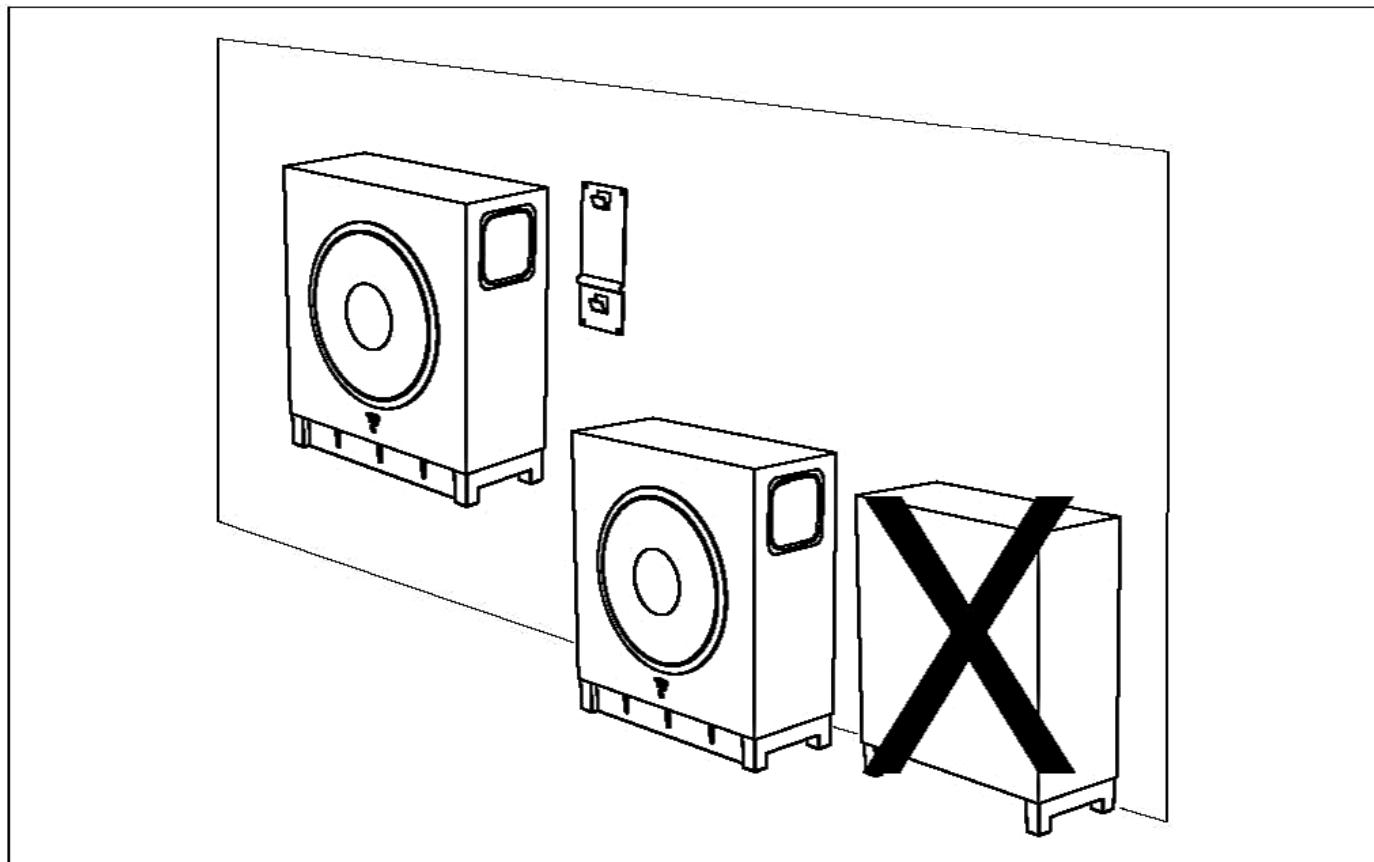
Utilisez le kit de fixation murale Sub Air. Fixez la partie femelle sur le Sub Air en utilisant les vis fournies. Fixez la partie mâle au mur à l'endroit où vous souhaitez installer le Sub Air. Ajoutez les plots en caoutchouc sur la face arrière du Sub Air.
