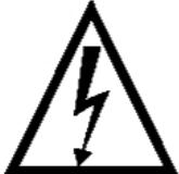
O símbolo de um relâmpago com uma ponta de seta, dentro de um triângulo equilátero, tem a intenção de alertar o utilizador para a presença de "tensão perigosa" não isolada dentro da caixa do produto, que pode ser de uma magnitude suficiente para constituir um risco de choque eléctrico às pessoas.
