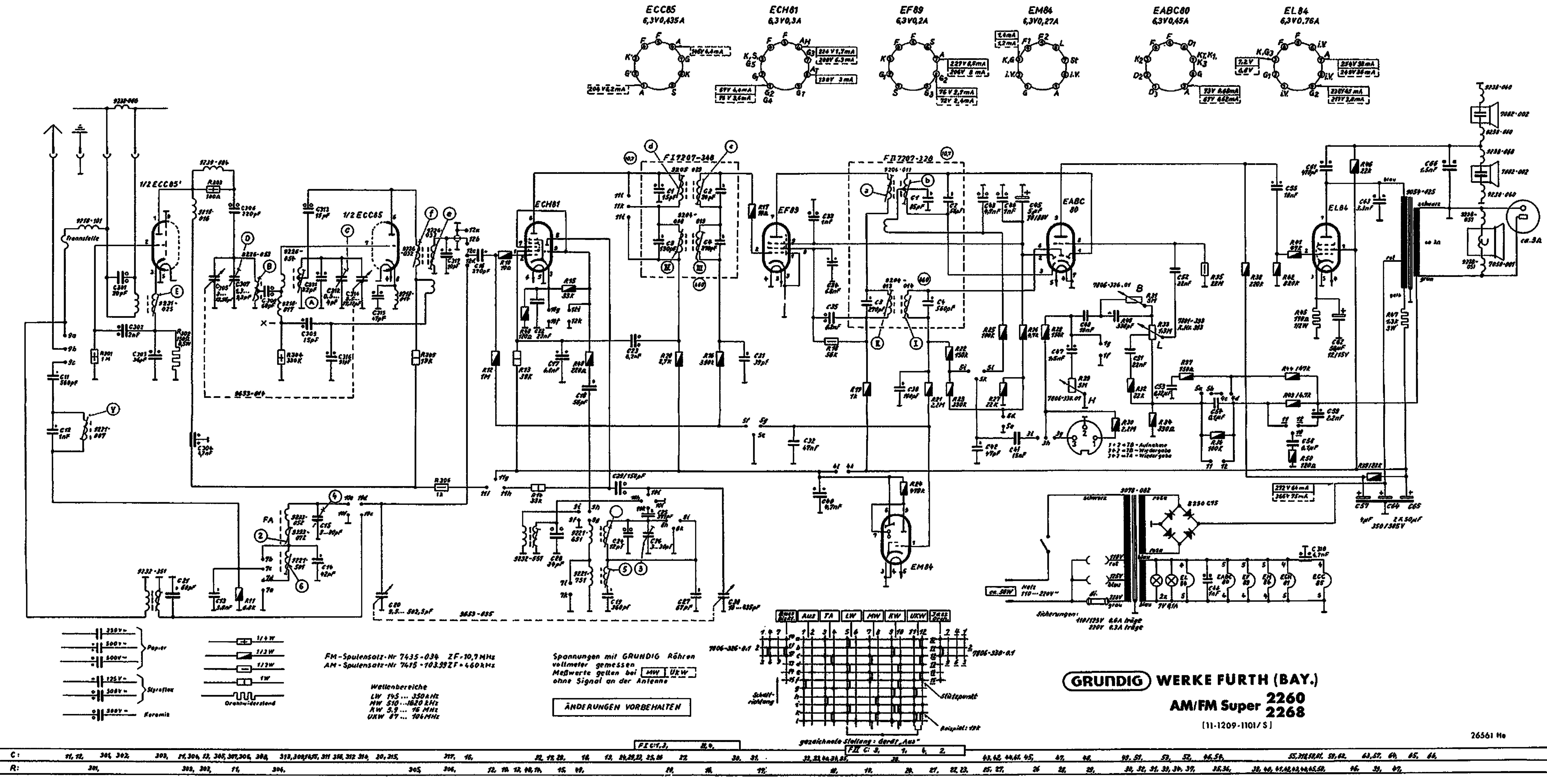
Schaltung: Superhet 6 (ECC 85, ECH 81, EF 89, EABC 80, EL 84, EM 84) Röhren: 6 AM-, 10 FM-Kreise Kreise: Wellenbereiche: UKW 87-104 MHz, KW 5,9-16 MHz, MW 510-1620 kHz, LW 145-350 kHz 3 (1 permanent-dynamisch, 2 elektrostatisch) Lautsprecher: Betriebsspannung: 110-220 Volt umschaltbar, Wechselstrom Gehäuse: Holz Skala: in kHz, MHz und Stationsnamen geeicht Abstimmung: Seilantrieb Gewicht: 8,5 kg Abmessung: Breite 54 cm Höhe 31,4 cm Tiefe 21,7 cm
