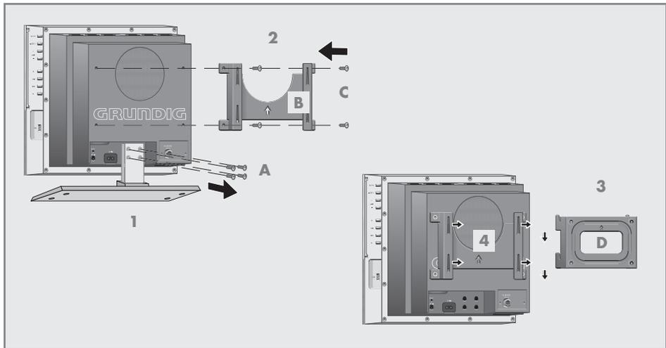
Zum Lieferumfang gehört eine Wandhalterung, mit der Sie die HiFi-Anlage an der Wand befestigen können.
