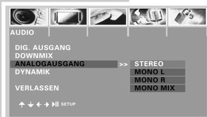
1 Zeile »ANALOG AUSGANG« mit »▼« oder »▲« anwählen und mit »▶« aktivieren.
