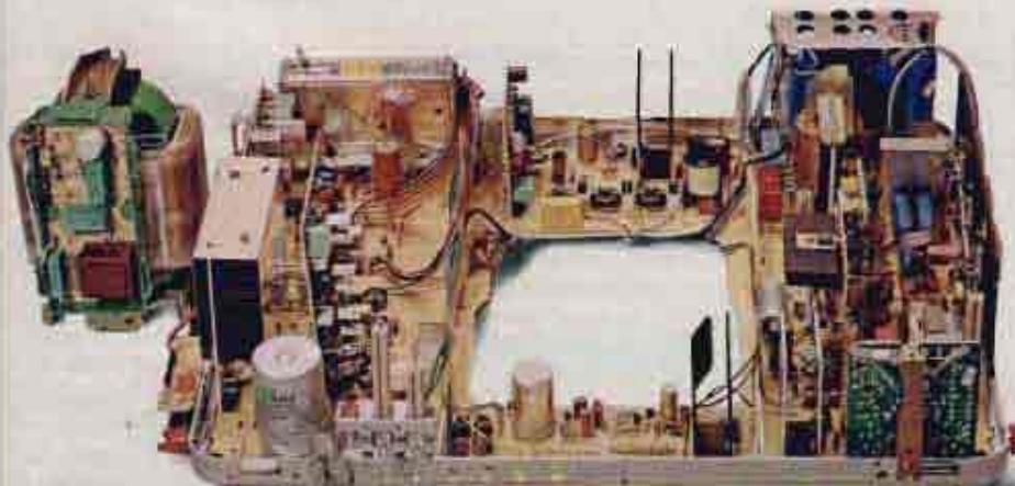
Das Grundig Sicherheitshassis mit der totalen Netztrennung
