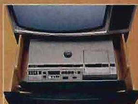
Der VCR-Untersatz des Modells S 9272 VCR geöffnet von oben, einen (extra lieferbaren) Video-Recorder SVR 4004 enthaltend. Wenn Fernseher und Recorder durch einen Video-Fernbedienungs-Adapter 1 (s. Seite 6/7) verbunden werden, können die Funktionen Vor- und Rücklauf, Aufnahme und Wiedergabe, Stop und Bandrückspülung in die Cassette vom Sitzplatz aus mit dem Tele-Pilot 160 E drahtlos ferngesteuert werden.
