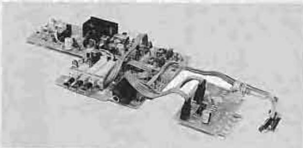
Bild 11 Cassettenplatte mit Aufnahmeinstellerplatte
