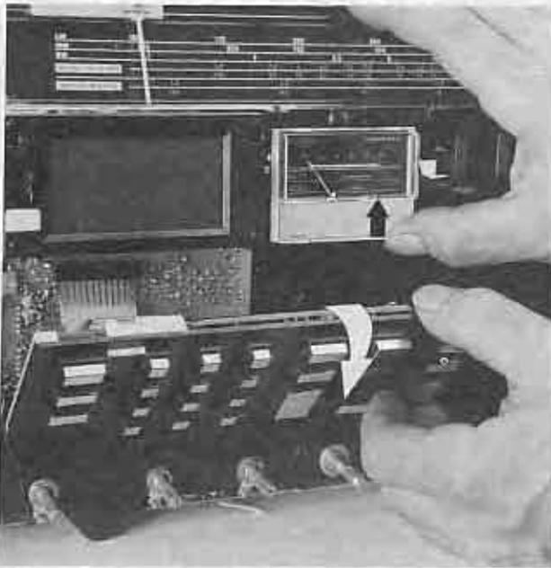
**Bild 5** Abstimm-Batterie-Anzeige-Instrument und abgeklapptes Tastenfeld
