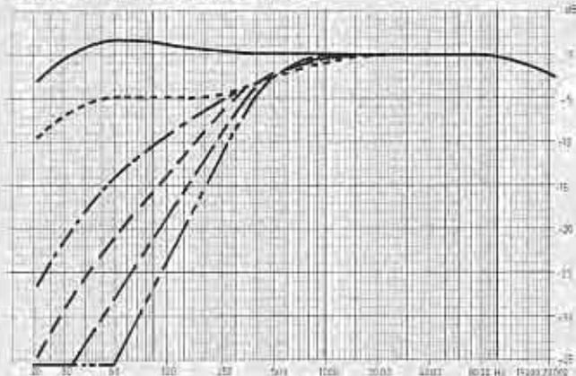
Bild 23 NF-Frequenzgang bei verschiedenen Baßstellerpositionen
