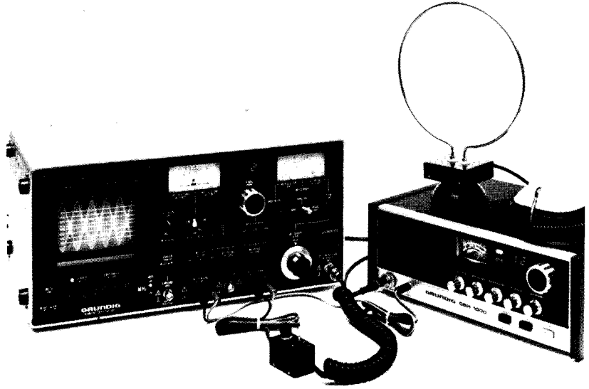
Bild 9 Meßaufbau für Sender- und Empfängerprüfung
