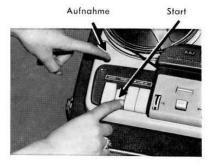
Es kann auch ohne dauerndes Drücken der Aufnahmetaste die richtige Aussteuerungs-Einstellung vorgenommen werden. Der Vorgang ist dann folgender: Stoptaste (Taste im Mittelfeld) drücken und durch Rückwärtsschieben einrasten, Aufnahmetaste drücken, Starttaste drücken, Aufnahmetaste wieder Ioslassen. Jetzt kann die Aussteuerungs-Einregelung erfolgen. Durch Lösen der Stoptaste wird nun der Bandlauf eingeschaltet.
