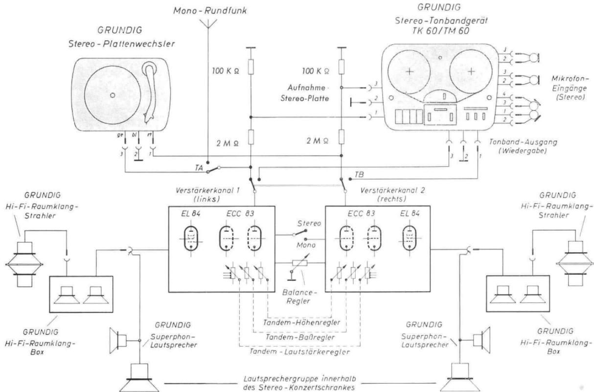
Prinzipschaltung der Stereo-Aufnahme und -Wiedergabe bei Verbindung des Tonbandgerätes TM 60 mit einem GRUNDIG Stereo-Konzertschrank
