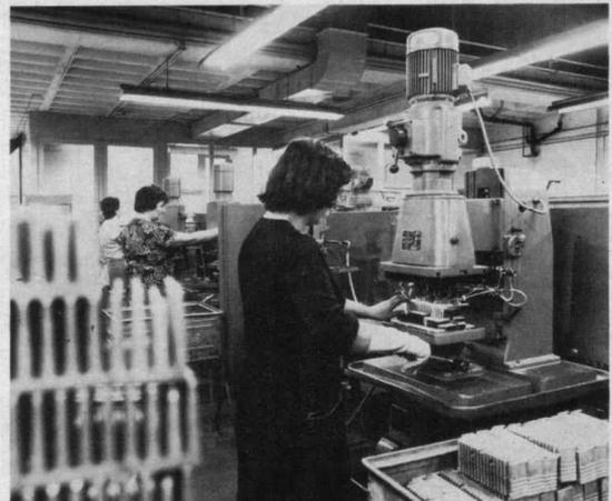
Bild 3 Weiterbearbeitung der Kühlkörper (Bohren von Gewinden für die Befestigung der Halbleiter)
