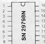
Bild 8 Anschluß-Belegung des SN 29798N IC 208
