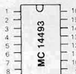
Bild 9 Anschluß-Belegung des MC 14493 IC 205
