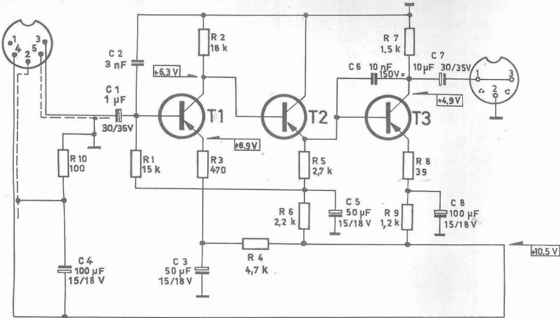
Spannungen mit GRUNDIG - Röhrenvoltmeter 6062 ( $R_i = 30 \text{ M}\Omega$ ) gemessen gegen Chassis
