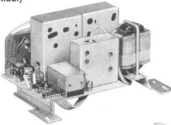
Für den nachträglichen Einbau in alle Super Color-Modelle ohne Sendersuchlauf einschließlich Farb-Portables. Zum Empfang von zwei oder mehr Secam-Farbprogrammen in L-Norm, wie sie die Sender Frankreichs und Luxemburgs im UHF-Bereich ausstrahlen. Bester Empfang an der Grenze nach Frankreich bzw. Luxemburg.
