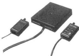
Die GRUNDIG Tele-Spiele-Cassette stellt ein universelles Einschub-System dar. In den Cassetten-schacht an der Gehäuseseite bestimmter Gerätetypen erfolgt durch Einschieben der Tele-Spiele-Cassette die elektrische Kontaktierung und Inbetriebnahme.
