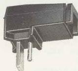
Besonders geeignet zum Lautsprecheranschluß an Autoradios. Montage ohne Lötarbeiten. Kabel wird nur abisoliert, eingeklemmt und Steckergehäuse zusammengepreßt.
