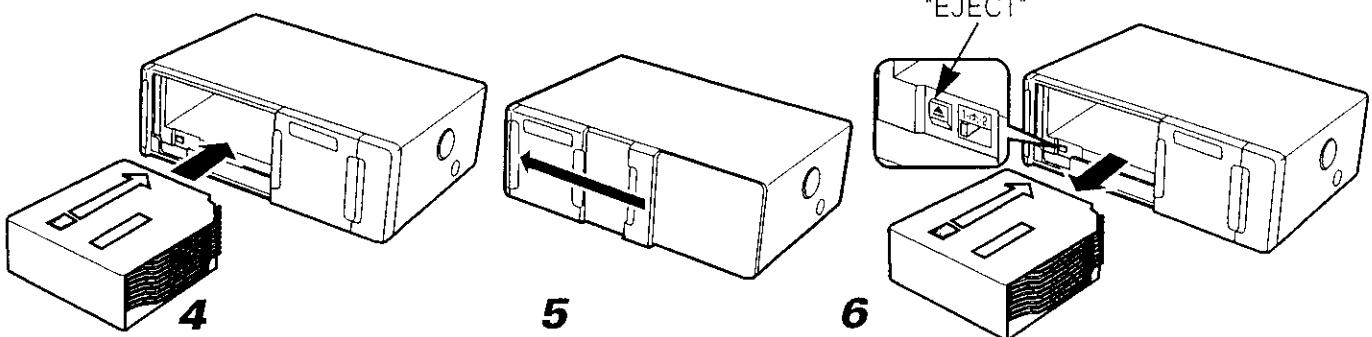
1. Asegúrese de que el cartucho de discos esté debidamente orientado hacia arriba, con el logotipo "disc" hacia arriba. Extraiga la bandeja por medio del saliente.
