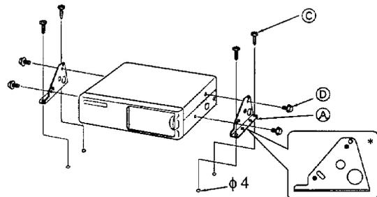
**Vertical installation / Installation verticale / Vertikaler Einbau
