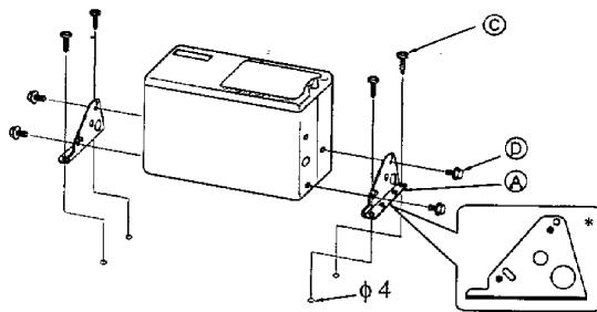
**In case of hanging in the trunk / Lorsqu'on suspend le changeur à l'intérieur du coffre
