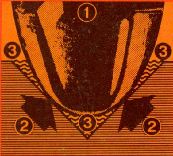
Abtastnadel ① liegt auf Flanken ② der Tonrinne. Nadel gleitet in kühlender Lencoclean-Flüssigkeit ③. Dies schont Platte und Diamant und verhindert Tonverzerrungen.
