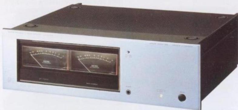
Diese Leistungsendstufe liefert mittels einer Parallel-Gegentaktschaltung eine kraftvolle Ausgangsleistung von 100 Watt pro Kanal (8 Ohm, 10 ... 20 000 Hz). Zum Einsatz kamen 4 Leistungstransistoren, die speziell für hohe Ausgangsleistung konzipiert sind. Die gesamte Schaltung ist gleichspannungsgekoppelt (DC) aufgebaut.
