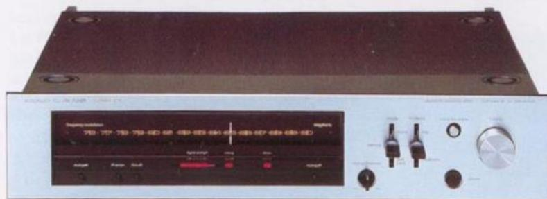
Bei diesem Tuner kam die von LUXMAN entwickelte „Closed-Loop-Locked“-Schaltung (C. L. L.), ein optimiertes Quarzfeinabstimmsystem, zum Einsatz, das eine absolut präzise und stabile Abstimmung ermöglicht. Sämtliche Stufen des Tuners werden genau auf die Frequenz der empfangenen Station abgeglichen. Das Accutouch-System bewirkt eine kurzzeitige mechanische Blockierung des Abstimmknopfes, wenn ein Sender exakt auf Ratiomitte abgestimmt ist.
