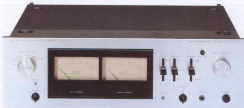
Beim 5 L 15 handelt es sich um einen integrierten Verstärker, der im wesentlichen die Entzerrerschaltung des 5 C 50 und die Leistungsendstufenschaltung des 5 M 21 beinhaltet. Die Endstufe ist mit 4 Leistungstransistoren bestückt, die speziell für hohe Ausgangsleistungen in parallelem Gegentaktbetrieb konstruiert wurden. Die Dauerausgangsleistung beträgt an 4 Ohm 120 Watt pro Kanal (DIN)
