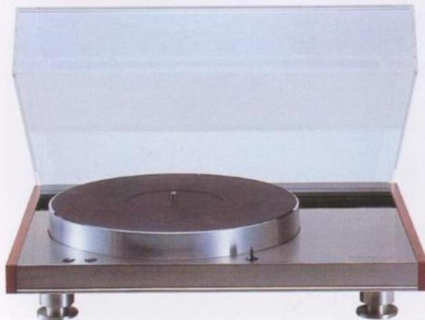
Der PD 441 ist ein direkt getriebenes PLL-Quartz-Locked-Laufwerk. Seine Besonderheit liegt jedoch in der Tatsache, daß es in der Lage ist, alle externen Belastungsschwankungen dank unseres exklusiven „Load-Free-Spindle“-Systems zu eliminieren. Der PD 441 ist identisch mit dem PD 444, kann jedoch nur mit einem Tonarm bestückt werden.
