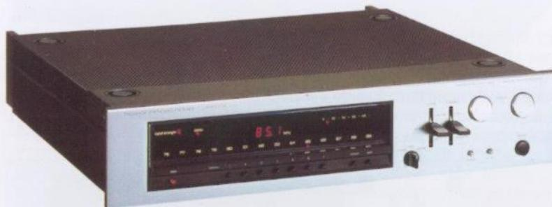
Der Tuner 5 T 50 arbeitet nach dem Prinzip der digitalen Frequenz-aufbereitung (Synthesizer, 100 kHz Raster) und wurde für HiFi-Enthusiasten und professionelle Anwender entwickelt. Mit Hilfe eines quarzgesteuerten Referenz-Oszillators wird eine exakte Abstimmung des gewünschten Senders erreicht. In einer vollelektronischen Schaltung wird die empfangene Frequenz mittels eines C-MOS IC's digital aufbereitet, d. h. eine leichte und schnelle Speicherung jeder gewünschten Station ist möglich.
