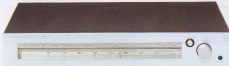
Der Tuner T 12 arbeitet mit dem „Accutouch“-System, das den exakten Abstimmpunkt im gesamten HF-Verstärkerteil festhält. Bei diesem System wird der genaue Mittenabstimmpunkt mit Hilfe einer Kontrollspannung an der Quarzschaltung bestimmt, die dann eine mechanische Blockierung des Abstimmknopfes auslöst, d. h. beim Abstimmvorgang wird bei präziser Mittenabstimmung der gewünschten Station der Knopf für etwa 1 Sekunde mechanisch verriegelt.
