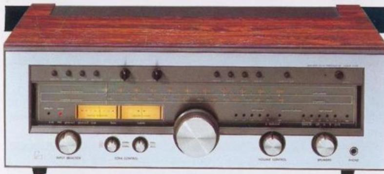
Topmodell der LUXMAN Receiver-Linie. Eingelassen in die elegante Frontblende des R 1120 ist eine aus 12 LED's bestehende Spitzenpegelanzeige, deren Empfindlichkeit umschaltbar ist. Das UKW-Teil arbeitet mit einer „Closed Locked Loop“-Schaltung (CLL), die einen präzise abgestimmten Sender festhält. Durch Bestückung der Eingangsstufe mit Dual Gate MOS FET's wurde eine Empfindlichkeit von  $0,9 \mu\text{V}$  (75 Ohm) erreicht.
