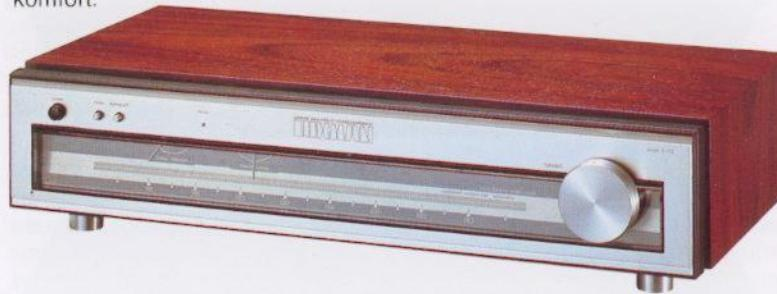
Der T 110 ist ein hochentwickelter UKW-Tuner. Seine einzigartigen Leistungen dokumentieren sich im anspruchsvollen Styling und einer modernen Schaltungskonzeption mit MOS FET's im Frontend, 5-fach Drehkondensator und phasenlinearen LC-Blockfiltern.
