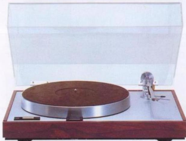
Ein bürsten- und schlitzloser Gleichstromservomotor und der gerade statisch ausbalancierte Tonarm mit niedriger Masse sind der Grund für die hervorragenden Gleichlaufschwankungswerte von kleiner als 0,03 % und dem exzellenten Signalrauschabstand von 60 dB. Der PD 277 ist die Automatikversion des PD 272.
