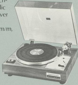
**6200** Riemenangetriebener Plattenspieler mit elektronisch geregelt Servomotor ● Automatische Tonarmrückführung und Endabschaltung ● Wiederholmöglichkeit ● Stroboskop zur Geschwindigkeits-Feineinstellung ● Antiskating einstellbar von 0,5 - 3,0 g ● Maße: 444 x 162 x 332 m/m, Gewicht 7,7 kg
