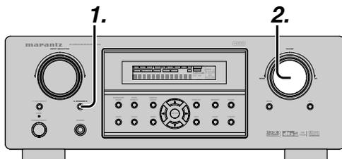
1. Drücken Sie die Taste **S (SURROUND) SPEAKER B**. Das Gerät schaltet auf den Modus für das Surround-Lautsprechersystem B um, und die Anzeige „**SPKR B**“ wird auf dem Display angezeigt.
