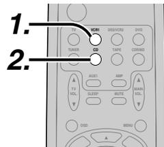
1. Schalten Sie die Videoeingangsquelle auf VCR1 um, indem Sie einfach die entsprechende **Eingangswahltaaste** auf der Fernbedienung drücken.
