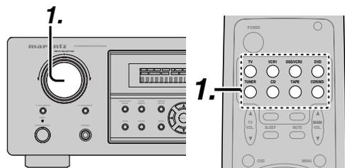
1. Wählen Sie die aufzunehmende Eingangsquelle, indem Sie den **Eingangsfunktionswahlregler (INPUT FUNCTION SELECTOR)** an der Frontplatte drehen bzw. einfach die entsprechende **Eingangswahltaaste** auf der Fernbedienung drücken. Damit ist die Eingangsquelle gewählt und Sie können sich das Signal von dieser Eingangsquelle wiedergeben.
