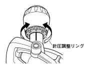
6. カウンターウェイトと針圧調整リングを 一緒に矢印方向に回し、ご使用のカート リッジの適正針圧値に合わせます。
