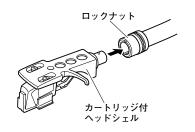
カートリッジ付へッドシェルをトーンアームに差し込み、ロックナットでしっかり固定します。
