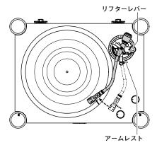
リフターレバーを下げたとき、トーンアームとターンテーブル面が平行になり、水平バランスがとれるようにカウンターウェイトを回します。
