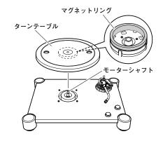
ターンテーブルシートをターンテーブル のモーターシャフトに合わせてのせてく ださい。
