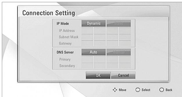
**Static (Statisch):** Wählen Sie diese Option, um IP-Adresse, Subnetzmaske, Gateway und somit die Einstellungen des DNS-Servers manuell einzustellen.
