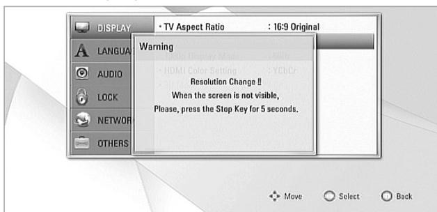
Bitte warten Sie 20 Sekunden, wenn der Bildschirm nach einer Änderung der Auflösung nicht angezeigt wird; die Auflösung wird dann automatisch auf die vorherige Einstellung zurückgesetzt, oder es wird eine Meldung (siehe Abbildung unten) eingeblendet.
