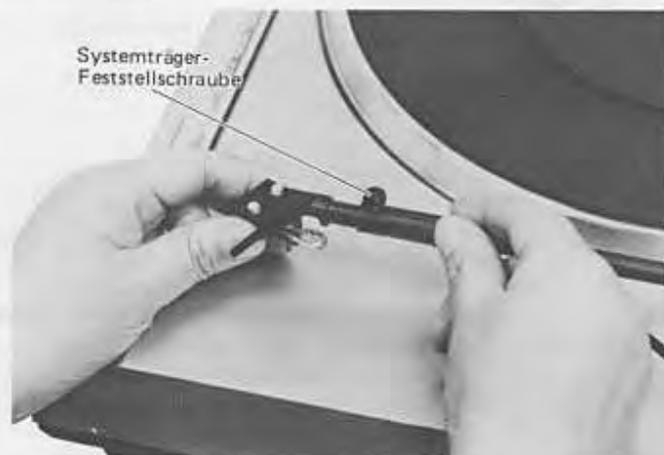
Das Gegengewicht 8 am hinteren Tonarmende aufschrauben und langsam in Pfeilrichtung drehen, bis der Tonarm ausbalanciert ist, d.h. im freigelassenen Zustand weder absinkt noch sich abhebt.
