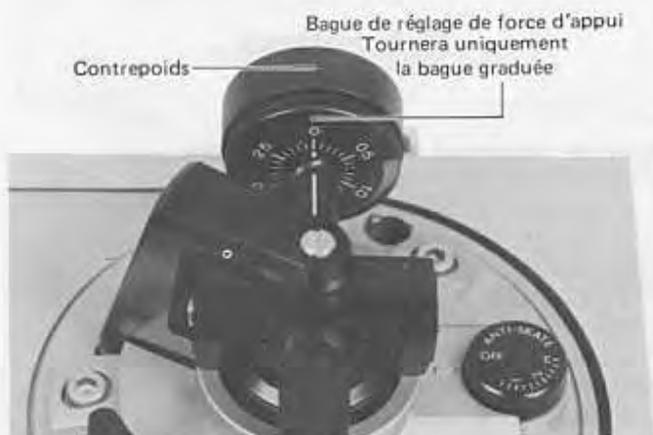
A présent, tourner le contrepois **8** dans le sens indiqué par la flèche (la bague graduée tournera en même temps), jusqu'à obtenir le réglage approprié de force d'appui qui correspond à la cellule utilisée.
