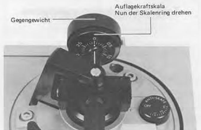
Nun das Gegengewicht langsam in Pfeilrichtung drehen (der Skalensring dreht sich mit), bis die für den Tonabnehmer geeignete Auflagekraft (im Falle des mitgelieferten Tonabnehmers Zg) an der Skala eingestellt ist.
