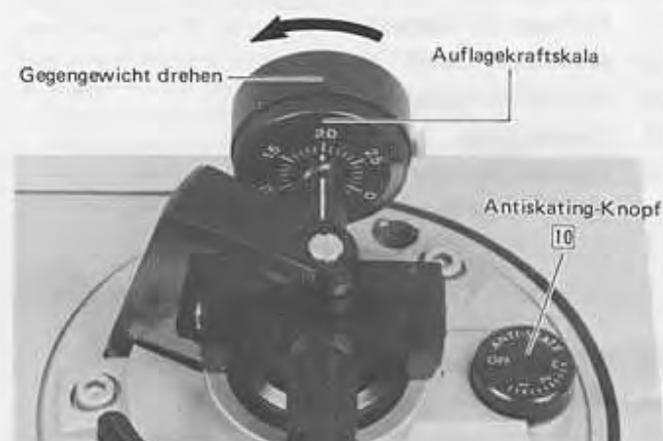
Nachdem die Auflagekraft richtig eingestellt wurde, den Antiskating-Knopf 10 auf den gleichen Wert einstellen. Wird dies nicht durchgeführt, dann könnte die Abtastnadel beim Abspielen einer Schallplatte aus der Schallrinne abrutschen.
