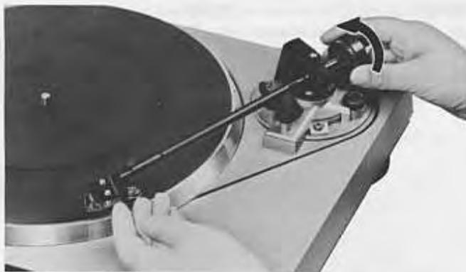
Estando el brazo sonoro en esta posición, alinee el '0' sobre el anillo **9** de la escala con la línea de referencia sobre el brazo sonoro, haciendo girar el anillo de la escala **9**. Adverta que el anillo de la escala gira a una con el contrapeso, el cual sin embargo no gira cuando sólo hay rotación del anillo de la escala.
