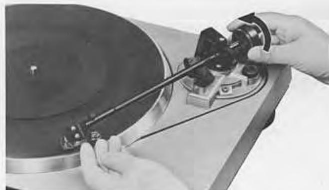
Nun die Nullmarkierung „0“ am Auflagekraft-Skalenring 9 mit der Bezugslinie am Tonarm ausrichten, indem der Skalensring gedreht wird. Dabei nicht am Gegengewicht drehen oder dieses verstellen, da der Tonarm sonst aus der Balance kommt.
