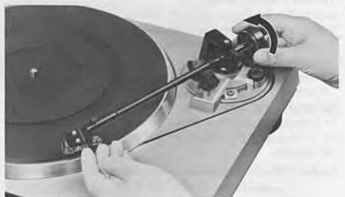
Quand cette position du bras est obtenue, aligner l'indication "0" de la bague graduée [9] avec la ligne de repérage gravée sur le bras en tournant la bague graduée [9]. A noter que la bague graduée tourne avec le contrepois, mais que le contrepois ne tourne pas quand la bague est tournée individuellement.
