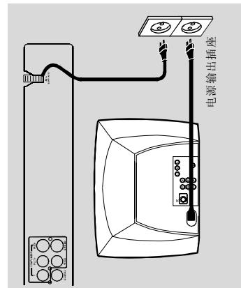
正确完成所有连接之后，将本机的交流电源线插入墙上的交流电源插座。
