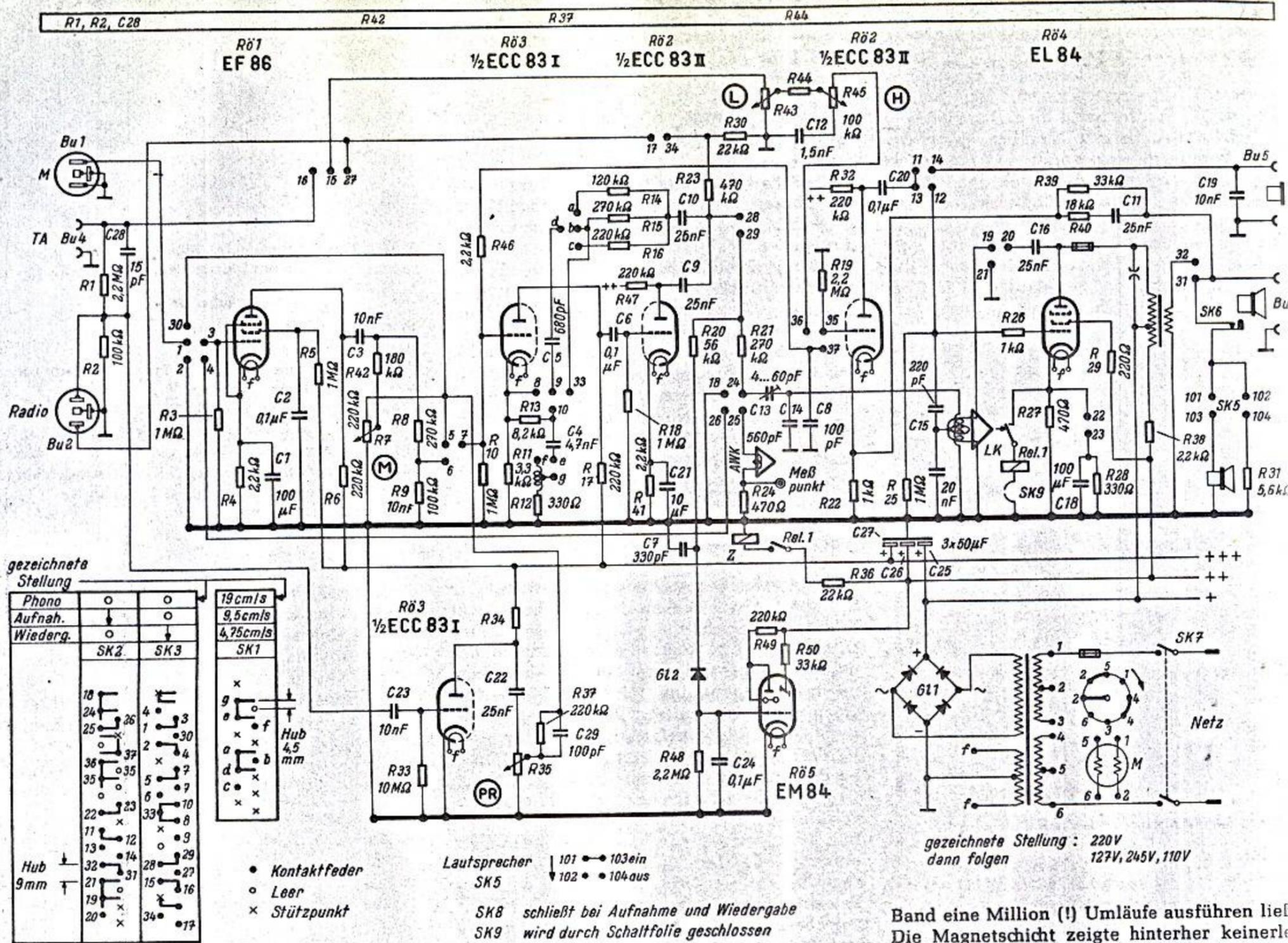
Kopf und zum Aussteuerungsmesser EM 84. Die Lautsprecher-Endröhre arbeitet dabei als Hf-Erzeuger. Das zweite System der ersten ECC 83 wird als Mithörröhre betrieben, die an Bu 5 eine Tonspannung zum Mithören über einen dort angeschlossenen Kopfhörer liefert. In Wiedergabeschaltung gelangt die Tonspannung vom zweiten System der ersten ECC 83 zum Lautstärkereglern L, von dort über R 44 an den Höhenregler H und schließlich zum Wiedergabeverstärker.
