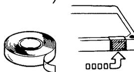
Pour enregistrer à nouveau, recouvrir l'orifice du taquet d'une bande adhésive.
