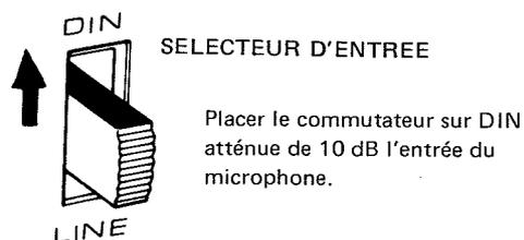
Placer le commutateur sur DIN atténué de 10 dB l'entrée du microphone.
