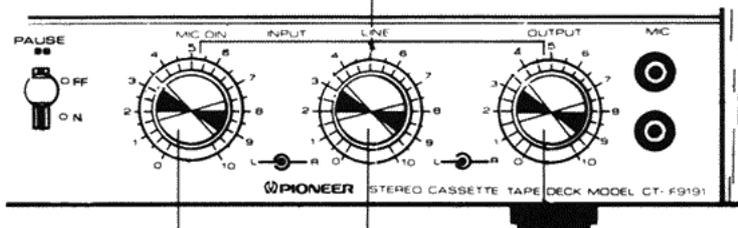
**MIC/DIN RECORDING LEVEL CONTROLS**
