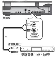
使用顯示裝置的 F.AUDIO 輸入插孔可輕易播放數位音訊 播放器或 PC 的音效。使用立體聲迷你插頭連接線將音 訊來源連接至顯示裝置。
