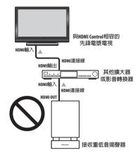
僅限連接您打算做爲本機 HDMI 輸入來源的設備。中 斷與其他擴大器或影音轉換器 (例如 HDMI 開關) 的直接連接可能導致操作上的錯誤。
