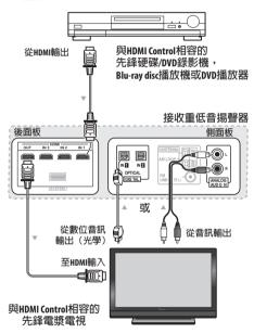
將電漿電視直接連接至本機。中斷與其他擴大器或 影音轉換器 (例如 HDMI 開關)的直接連接可能導 致操作上的錯誤。
