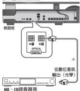
將側面板的 OPTICAL IN 2 插孔連接至外接播放設備 的光學輸出插孔。
