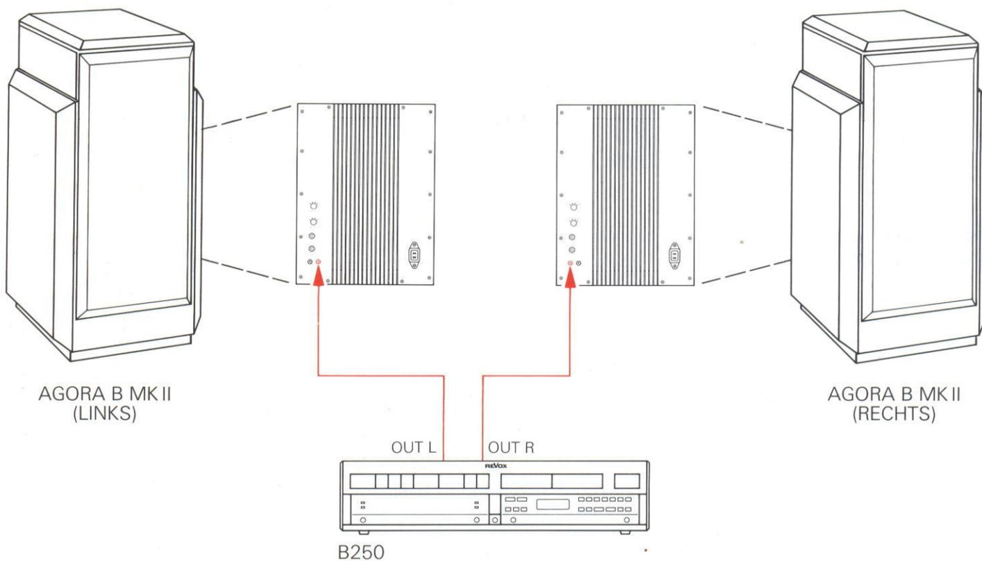
Der linke Verstärkerausgang wird durch ein einadriges, abgeschirmtes Verbindungskabel mit der Eingangsbuchse "INPUT L" des linken Aktivlautsprechers verbunden. Der Schalter INPUT SELECTOR [3] der linken Box muss entweder auf "PRE AMP L" (Vorverstärker) oder "PWR AMP L" (Vollverstärker) stehen.
