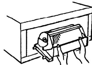
6 Reposer le couvercle de magasin et le verrouiller avec la clé.
