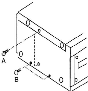
Um die Vibrationsfestigkeit des CDC 100 zu erhöhen, können auf beiden Seiten je 2 Schrauben [B] gelöst werden. Damit lagert das innere Chassis schwimmend im äusseren.
