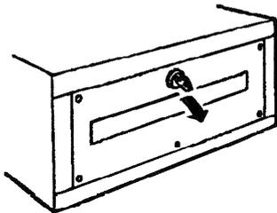
2 Soulever le levier de sécurité (sous le magasin à CD) et sortir le magasin en même temps.
