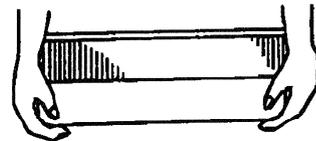
5 Introduire le magasin plein dans les guidages correspondants et soulever en même temps le levier. Une fois le magasin installé, presser dessus des deux côtés jusqu'à encliquetage.
