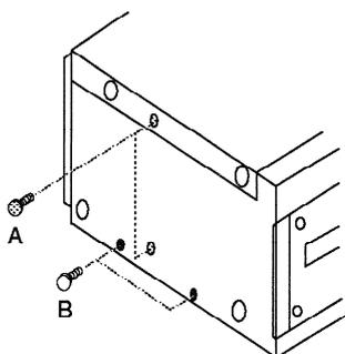
Pour accroître la résistance du CDC 100 aux secousses, on peut desserrer 2 vis [B] de chaque côté. Le châssis intérieur "flotte" ainsi par rapport au châssis extérieur.
