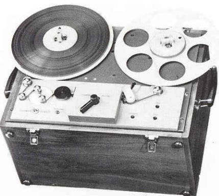
Studer 27. Oben die Verstärkereinheit, die auch als Reportagemischpult diente.
