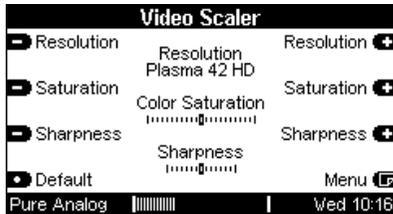
Eine Verschiebung aus der neutralen Mittelstellung in den positiven Bereich verstärkt die Farbsättigung und führt zu kräftigeren Farben.
