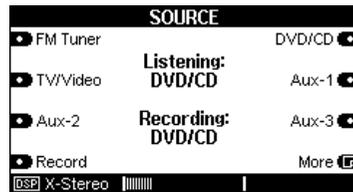
Danach rufen Sie das DVD-Setup auf, indem Sie die Taste **Setup** für ca. 2 Sekunden auf der Frontseite des **M51** drücken und anschließend den Softkey **Source** wählen.
