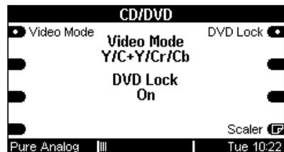
Mit dem Softkey **Scaler** erreichen Sie das DVS-Setup.
