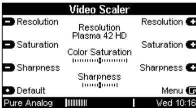
**Seite 2** ermöglicht die Anpassung der Bildgröße sowie die verschiedenen Ausgabevarianten für den digitalen HDMI- als auch für den analogen Ausgang an.
