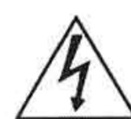
Le symbole à flèche brisée dans un triangle équilatéral a pour but d'attirer l'attention de l'utilisateur sur la présence, à l'intérieur du coffret, d'une "tension dangereuse" non isolée qui est d'une importance suffisante pour constituer un risque de décharge électrique pour les êtres humains.
