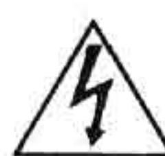
Il simbolo del lampo a punta di freccia all'interno di un triangolo equilatero serve a cautelare l'utente sulla presenza di "tensione pericolosa" non isolata all'interno del mobile tale da costituire un rischio di scossa elettrica.
