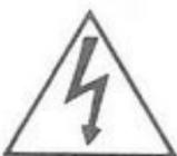
Der Blitz mit dem Pfeil an der Spitze in einem gleichschenkligen Dreieck soll den Benutzer vor nicht isolierter "gefährlicher Spannung" im Produkt warnen, die eine Stromschlaggefahr für Personen darstellen kann.
