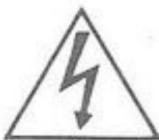
Le symbole à flèche brisée dans un triangle équilatéral a pour but d'attirer l'attention de l'utilisateur sur la présence, à l'intérieur du coffret, d'une "tension dangereuse" non isolée qui est d'une importance suffisante pour constituer un risque de décharge électrique pour les êtres humains.
