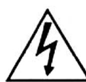
Der Blitz mit dem Pfeil an der Spitze in einem gleichschenkligen Dreieck soll den Benutzer vor nicht isolierter "gefährlicher Spannung" im Produkt warnen, die eine Stromschlaggefahr für Personen darstellen kann.
