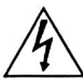
Le symbole à flèche brisée dans un triangle équilatéral a pour but d'attirer l'attention de l'utilisateur sur la présence, à l'intérieur du coffret, d'une "tension dangereuse" non isolée qui est d'une importance suffisante pour constituer un risque de décharge électrique pour les êtres humains.
