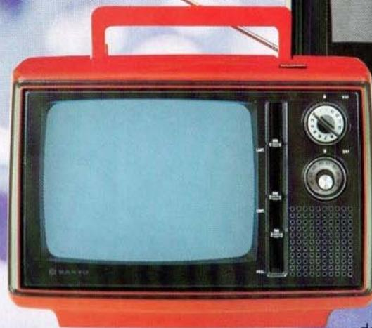
réglage du volume, de la luminosité et du contraste. Boîtier en matière synthétique livrable en blanc ou en rouge. Alimentation secteur 220 V ou par accu. 12 V. Dimensions L x H x P: 350 x 249 x 265 mm, poids 5,8 kg.
