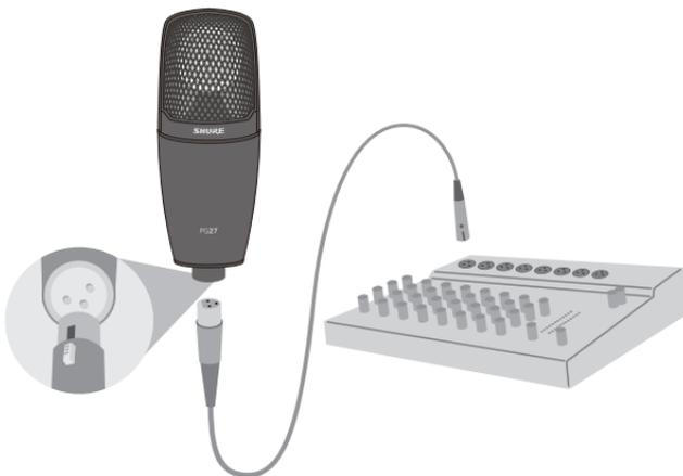
**Nota:** Los micrófonos de condensador tales como el PG27 requieren de alimentación phantom suministrada por la mezcladora, preamplificador o consola.
