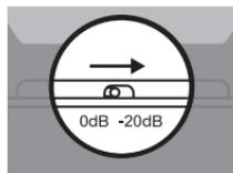
L'attenuatore commutabile previene la distorsione proveniente da sorgenti sonore molto forti, come ad esempio quelle dovute alla vicinanza del microfono a fiati e batterie.
