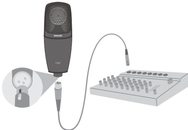
**Nota:** I microfoni a condensatore quali il PG27 richiedono alimentazione virtuale fornita da un mixer, un preamplificatore o una consolle.
