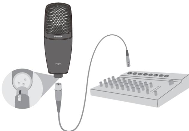
**Hinweis:** Kondensatormikrofone wie das PG27 erfordern Phantomspannung durch einen Mischer, einen Vorverstärker oder eine Konsole.
