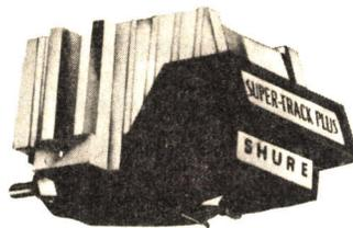
La V15 type III la "Shure second best", est la plus performante après la V15 type IV, avec sa force d'appui de 0,75 à 1,25 g et son noyau magnétique révolutionnaire à structure laminée, son équipage mobile à masse très réduite, son coefficient de trackabilité exceptionnel, sa réponse en fréquence plate et sa dynamique très élevée.
