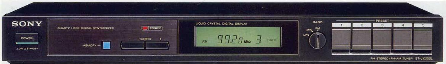
**ST-JX 220 L.** Sie sehen genau, was Sache ist. Der ST-JX 220 L hat ein informatives Digital-Display zur Anzeige aller wesentlichen Funktionen. So zeigt zum Beispiel die Abstimmmanzeige exakt an, wenn ein ausreichend starkes Sendersignal empfangen wird und der Tuner richtig abgestimmt ist. Damit diese Abstimmung exakt bleibt, verfügt der ST-JX 220 L über einen hochkonstanten, quartzgesteuerten
